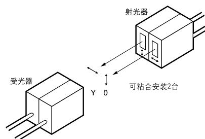
· 在外罩上印刷的箭头表示偏光方向，如上图，改变一组射光器 / 接受器的偏光方向，可以防止相互干扰。(射光器与接受器的偏光方向必须一致。)
