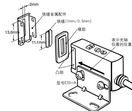
将狭缝插入二眼透镜的内「表示光轴位置箭头标记」所指的位置。(卧式使用下侧透镜，立式采用上侧透镜。)
