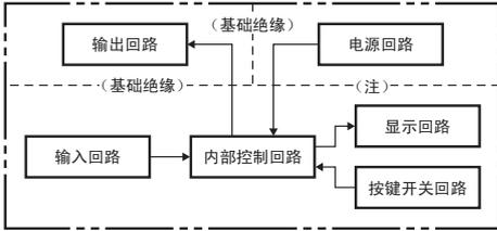
注：电源与输入回路为基础绝缘。（但H5CZ-□D为非绝缘。）
