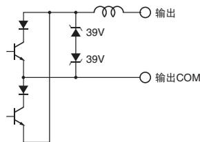
注：虽然输出端子与内部回路是电气绝缘的，但也不要再在这些端子上进行绝缘电阻测量和耐电压试验。
