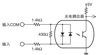
注：虽然输入端子与内部回路是电气绝缘的，但也不要再在这些端子上进行绝缘电阻测量和耐电压试验。
