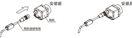
■拆除 将相机连接电缆侧接口向箭头→方向推入的同时笔直拔出。
