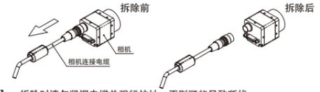
【注意】拆除时请勿紧握电缆并强行拉扯, 否则可能导致断线。
