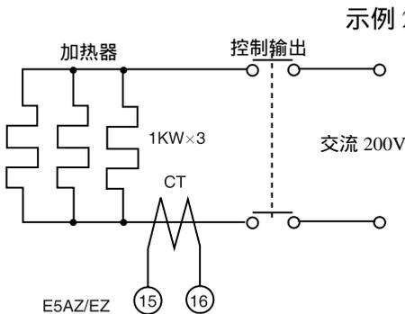
示例 2 使用 3 个 200VAC、1kW 加热器时
