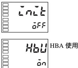
“加热器断线”参数的初始值已设为“ON”，设置“加热器断线检测”参数。
